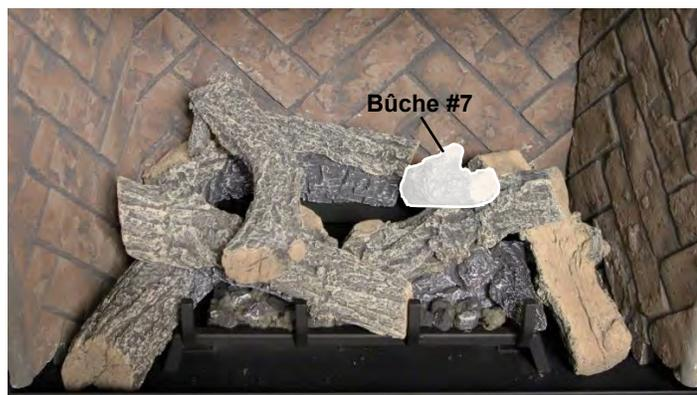
**Étape 8 :** Placez la **bûche #7** sur l'espace libre du support de bûches arrière et sur la bûche #4 en faisant attention de la positionner également entre les flammes du bout et du centre. Il ne doit pas y avoir de choc de flammes, cela pourrait faire de la suie.
