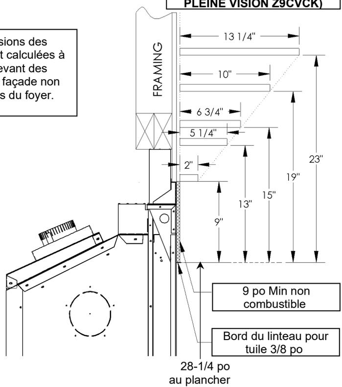
**Avertissement : Ne pas placer de matériel combustible sur un manteau non combustible sauf si le manteau non combustible respecte les dimensions minimales requises pour un manteau combustible.**
