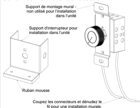
**ATTENTION : NE PAS BRANCHER LE VENTILATEUR 120 VOLTS AU SYSTÈME MILLIVOLT DE LA VALVE À GAZ**
