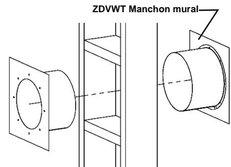
**NB: la sortie de ventilation ne doit pas être encastré dans le mur ou le revêtement extérieur.**
