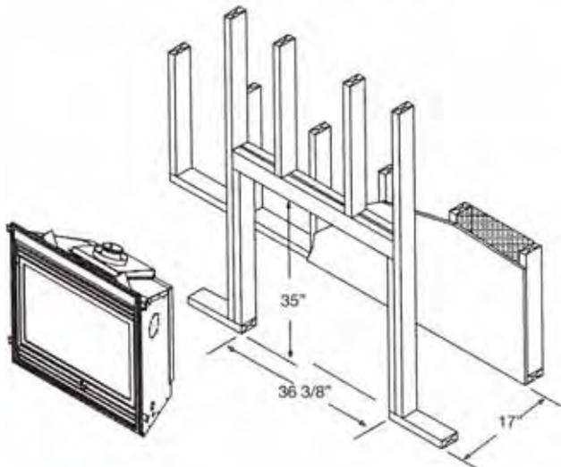
N.B. : Lorsque vous ajoutez un encadrement mural MQHB36SW, le foyer doit être surélevé d'au moins 3 1/2 po au dessus du plancher fini afin de laisser l'espace pour l'encadrement. (Voir page suivante) :
