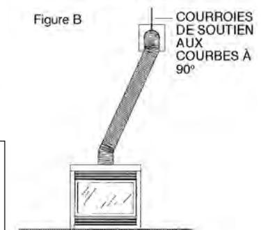
Pour les installations horizontales pour gaz propane il est requis qu'il y ait au moins 1pi de conduit vertical à partir du carneau du foyer avant le coude sur tout conduit horizontal de 1pi ou plus. Cela permet une combustion plus propre et réduit de beaucoup les dépôts de carbone et le besoin de nettoyer la vitre. (Ne s'applique pas aux modèles à carneau arrière).
