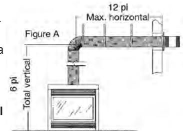
**N.B. : L'emplacement final du foyer doit être tel que les dimensions du conduit horizontal soit les mêmes que celles mentionnées dans le tableau. La longueur maximale du conduit vertical est de 40pi (12.2m).**
